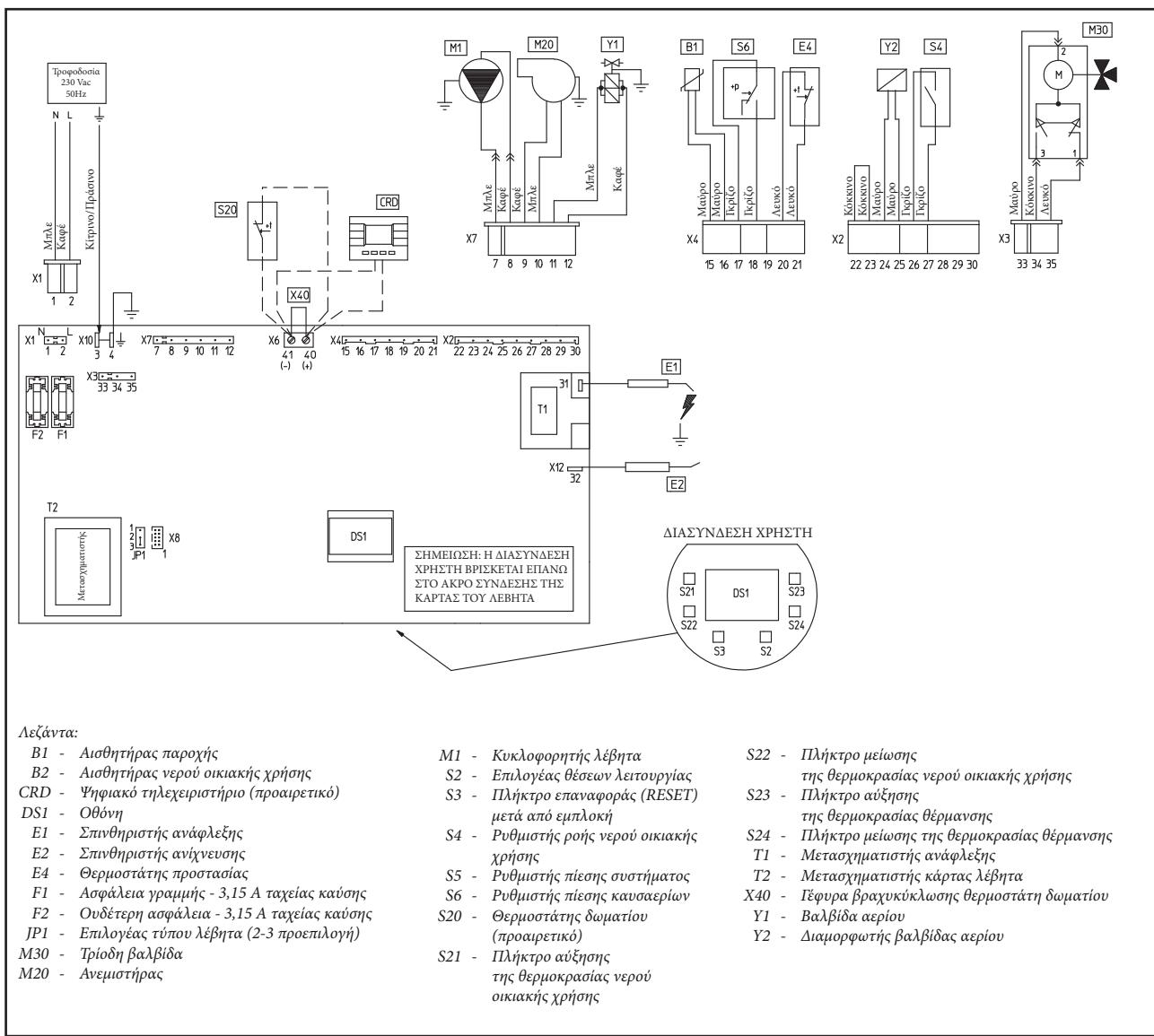
Ο λέβητας είναι σχεδιασμένος για την εφαρμογή θερμοστάτη δωματίου (S20), χρονοθερμοστάτη δωματίου On/Off, ρολόι προγραμματισμού ή ψηφιακού τηλεχειριστηρίου (CRD). Συνδέστε τους ακροδέκτες 40 - 41 εξαλείφοντας τη γέφυρα βραχυκύλωσης X40.
