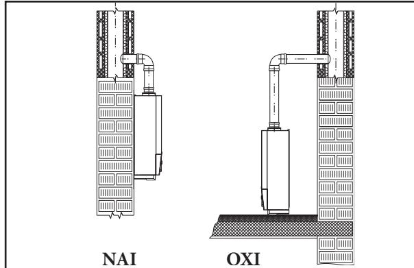
**Προσοχή:** Η εγκατάσταση του λέβητα σε τοίχο, πρέπει να εξασφαλίζει σταθερή και αποτελεσματική στήριξη για τη γεννήτρια.
