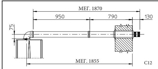
Σύνδεση με μία προέκταση. Η μέγιστη απόσταση μεταξύ του κάθετου άξονα του λέβητα και του εξωτερικού τοίχου είναι 1855 χιλιοστά.
